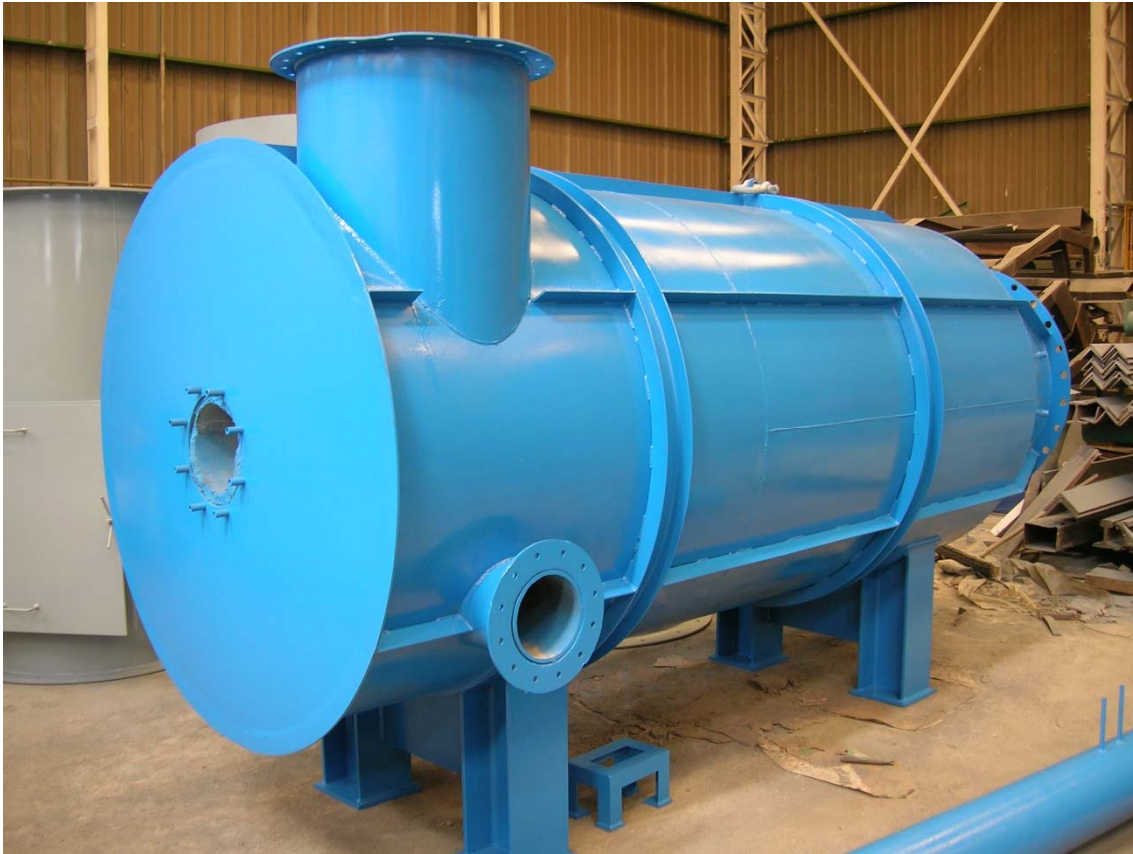
Fotografía 3: Cámara de oxidación.
