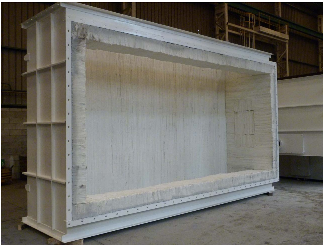
Fotografía 12: Aislamiento de un segmento de cámara de oxidación con fibra cerámica colocada en bandas perpendiculares a la chapa.
