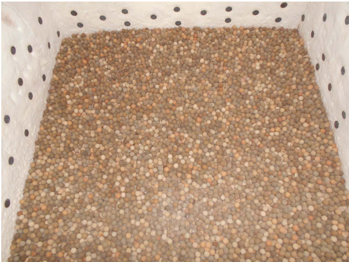
Fotografía 3: Torre rellena de bolas cerámicas.
