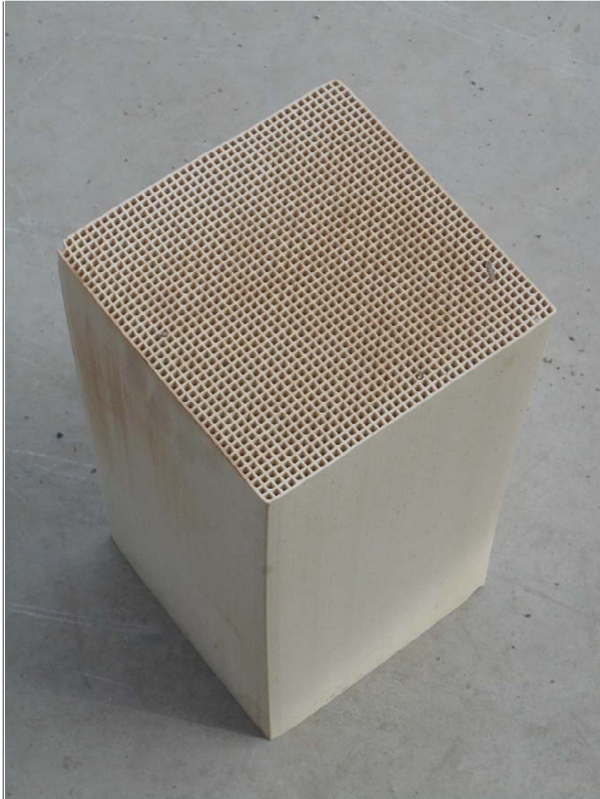
Fotografía 4: Bloque cerámico tipo "Honeycombs". ( +info )
